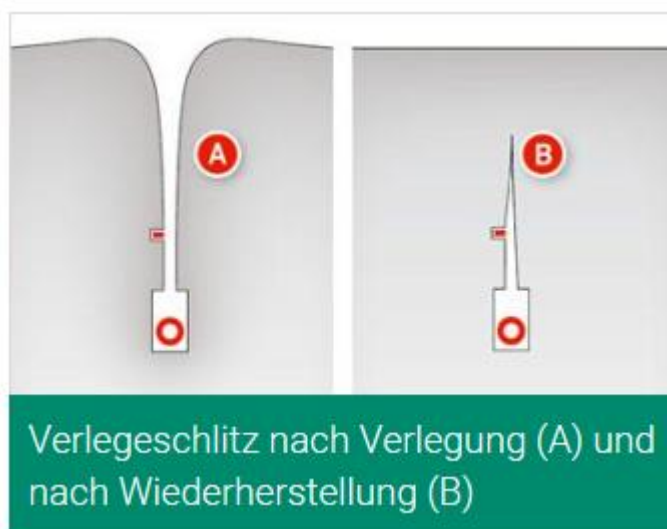
Abbildung 8: Schematischer Querschnitt einer Kabelverlegung durch Pflug 4
